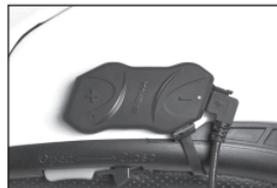
Puede utilizar el conector de 2 pines para el adaptador de micro USB para cargar el SMH10R sin la batería. Debe conectar el cable USB de alimentación y datos en primer lugar al conector de 2 pines para el adaptador de micro USB y, a continuación, a la batería SC-A0301 en serie. La batería se vende por separado como accesorio opcional.
