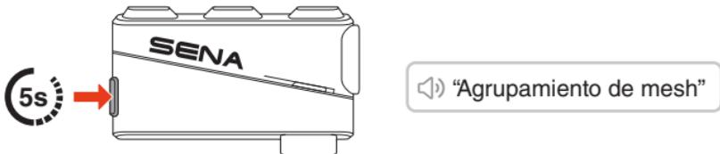
2. Cuando el agrupamiento de mesh se ha completado, automáticamente cambia de Open Mesh a Group Mesh.
