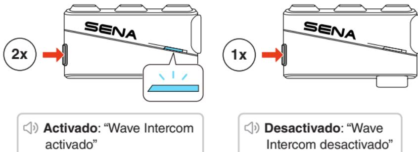
Si inicia Wave Intercom, se conectará automáticamente a los usuarios que estén en la zona Wave. La zona Wave cubre un radio de 1 millas en Norteamérica y un radio de 1,6 km en Europa.
