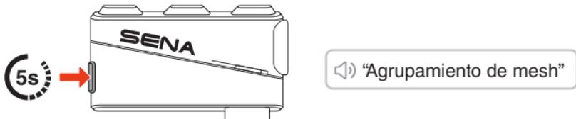
2. Una vez completado el agrupamiento de mesh, el resto de usuarios, C y D, se unen automáticamente a la group mesh a la vez que salen de la open mesh.
