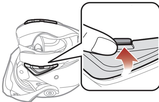
3. Tout en enfonçant la languette, insérez l'outil de service dans la rainure et appuyez pour retirer la visière.
