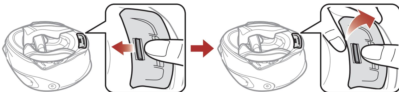
5. Détachez les fermoirs à pression des rembourrages internes et retirez les rembourrages du casque moto.
