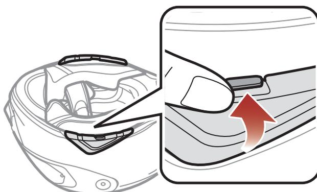
2. Tout en enfonçant la languette, insérez l'outil de service dans la rainure et appuyez pour retirer la visière.
