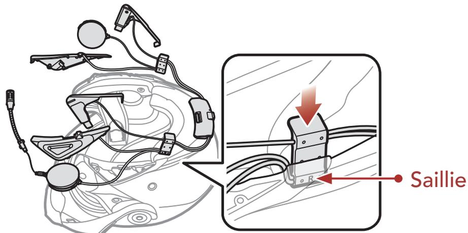
4. Insérez l'extrémité courte de l'antenne à côté de l'attache insérée et faites-la glisser entre les coques interne et externe.
