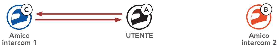
3. L'**utente (A)** può chiamare il **secondo amico intercom (B)** premendo due volte il **Pulsante centrale**, oppure il **secondo amico intercom (B)** può unirsi alla conversazione intercom effettuando una chiamata intercom all'**utente (A)**.
