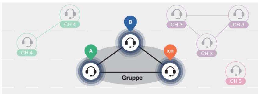
1. Benutzer (Sie, A und B) treten der Mesh-Gruppierung bei, indem sie die mittlere Taste 5 Sekunden lang gedrückt halten, während sie sich im Open Mesh befinden. Sie müssen sich nicht im selben Open Mesh-Kanal befinden, um ein Group Mesh zu erstellen.
