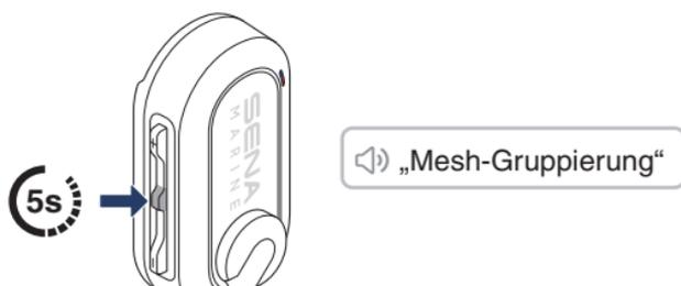
2. Wenn die Mesh-Gruppierung abgeschlossen ist, schließen sich die anderen Benutzer C und D automatisch dem Group Mesh an, während das Open Mesh bestehen bleibt.
