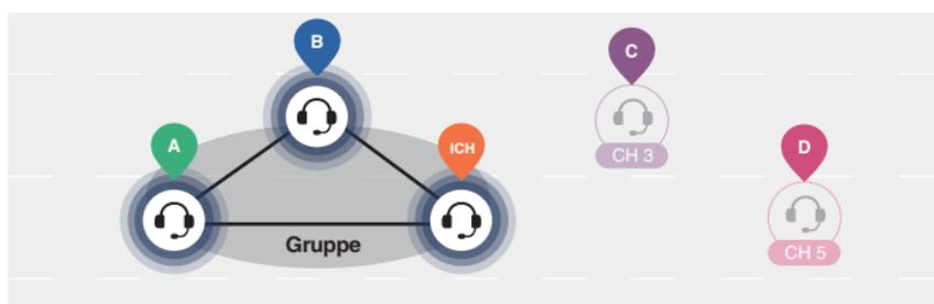
Sie befinden sich bereits in einem Group Mesh mit A und B und die anderen Nutzer, C und D, befinden sich in einem Open Mesh.
