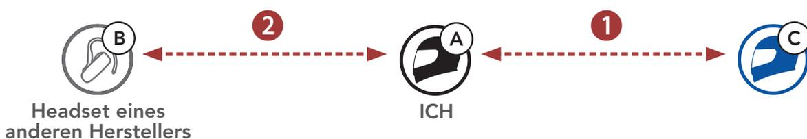
2. Starten Sie mit einem Bluetooth-Headset eines anderen Herstellers **(B)** die Kommunikation über die Sprechanlage in Ihrer Sprechanlagenengruppe. Beispielsweise können **Sie (A)** über die Sprechanlage die Kommunikation mit dem Bluetooth-Headset eines anderen Herstellers **(B)** beginnen. Alternativ kann der Gesprächsteilnehmer mit dem Bluetooth-Headset eines anderen Herstellers **(B)** **Sie (A)** über die Sprechanlage anrufen.
