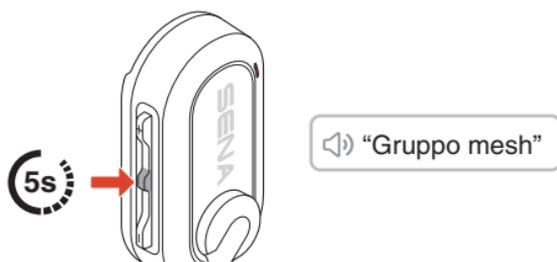
2. Quando il gruppo mesh viene portato a termine, passa automaticamente da open mesh a group mesh.
