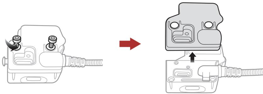
3. Retirez le tampon en caoutchouc et remplacez-le par le tampon en caoutchouc plus épais, inclus dans le package.
