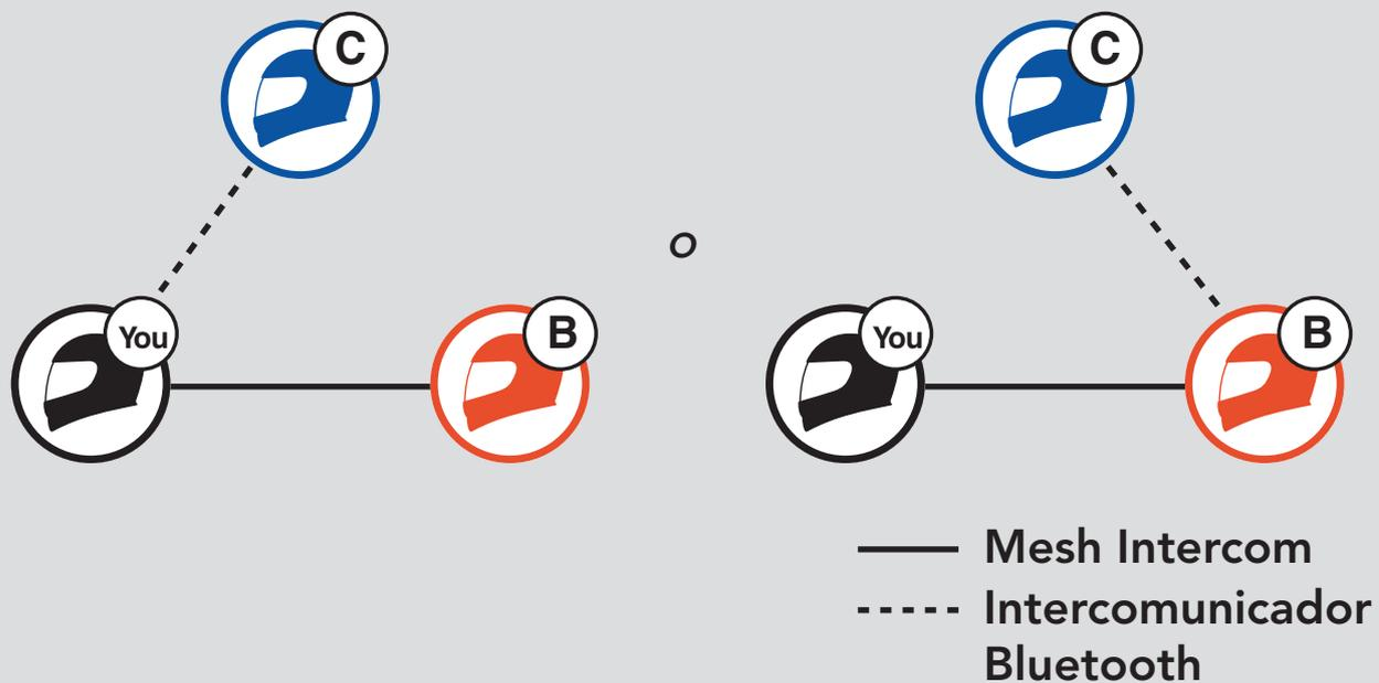
Si el amigo de intercomunicador Bluetooth (C) se conecta con **Intercomunicador Bluetooth** a usted y B (que usan **Mesh Intercom**), se creará un bucle cerrado y oirán mucho ruido.
