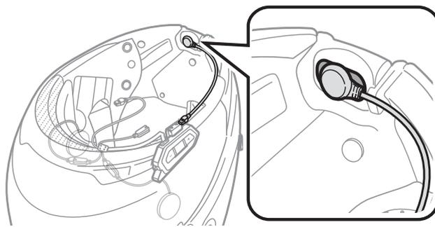
3. Alinee las flechas de los cables de la unidad principal y el micrófono e inserte el cable del micrófono en el conector del micrófono.
