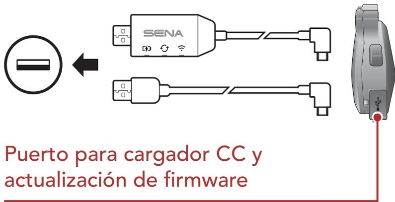
Puede cargar el auricular conectando el **WiFi Charging Cable** o un **cable USB de corriente y datos (USB-C)**.
