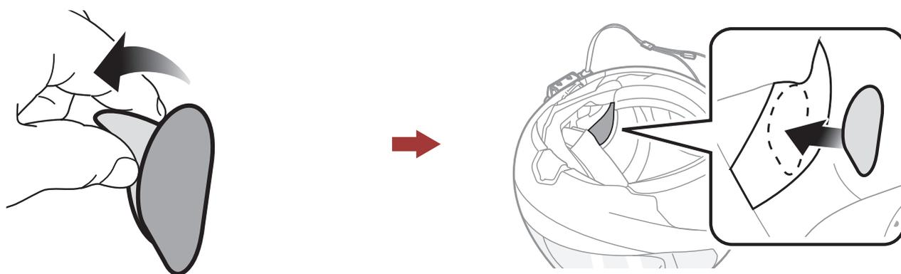
2. Pegue los altavoces a las sujeciones con cierre autoadherente de bucle para altavoces en el interior del casco.
