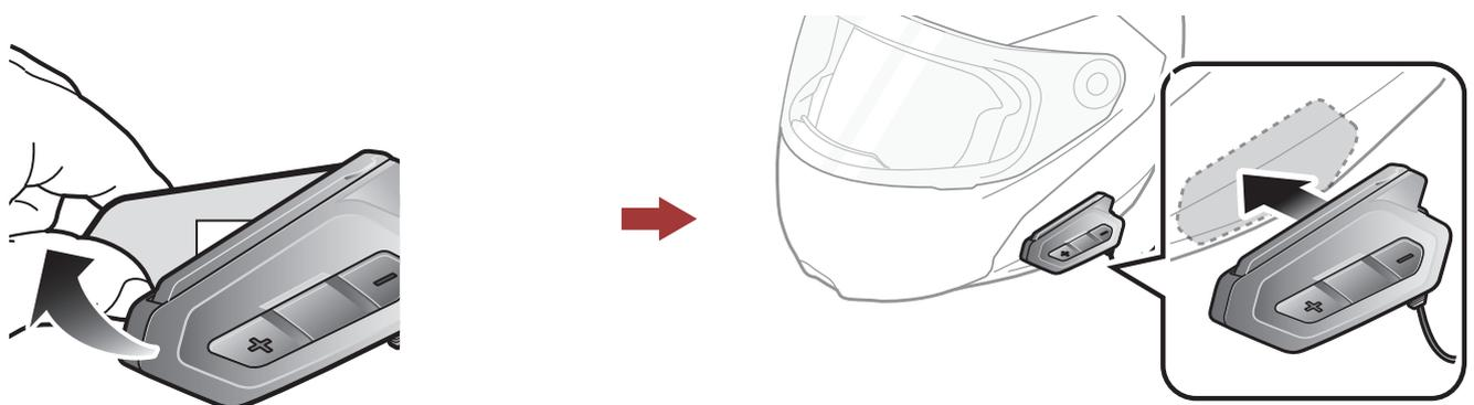
4. Asegúrese de que la unidad principal se adhiera al casco firmemente. La adhesión máxima se produce tras 24 horas.
