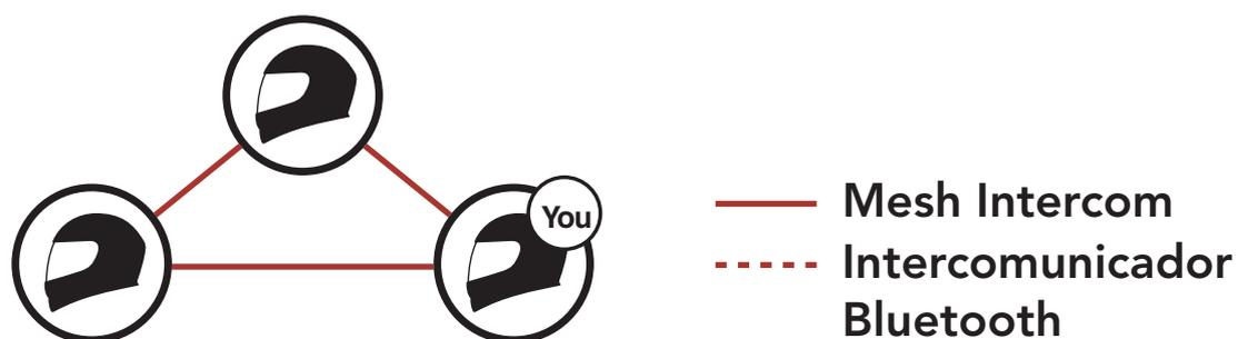
2. Cuando pulse el **Botón central** para iniciar una conversación a dos vías a través del intercomunicador con el primer amigo de intercomunicador Bluetooth (B), su amigo de intercomunicador Bluetooth (B) se unirá a **Mesh Intercom**.
