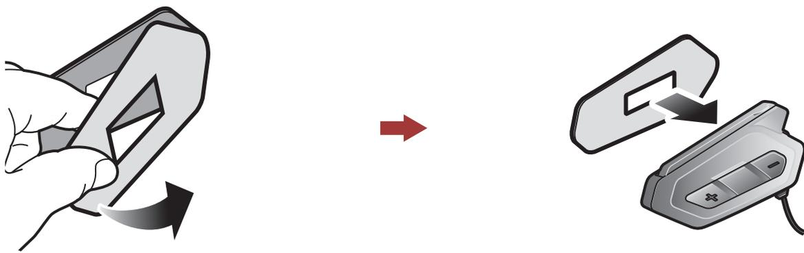
3. Retire la cubierta desde el otro lado de las cintas adhesivas de doble cara y coloque la unidad principal en el lado izquierdo del casco.
