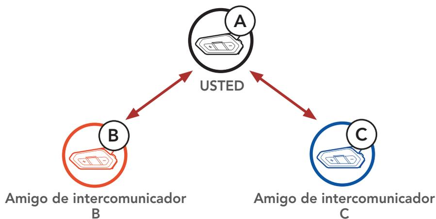
2. Inicie una conversación a través del intercomunicador con uno de los dos amigos de su grupo de intercomunicación. Por ejemplo, **usted (A)** puede iniciar una conversación a través del intercomunicador con el **amigo de intercomunicador (B)**. O el **amigo de intercomunicador (B)** puede iniciar una llamada de intercomunicador con **usted (A)**.
