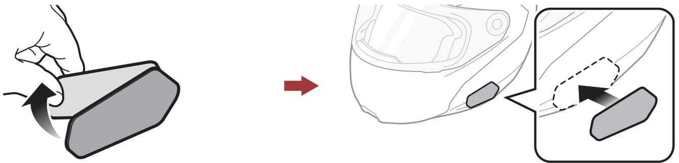
3. Retire la cubierta de la cinta adhesiva de la sujeción con cierre autoadherente de gancho para la unidad principal y péguela en la placa posterior de la unidad principal.
