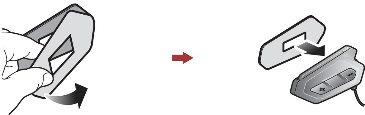
4. Coloque la unidad principal utilizando las sujeciones con cierre autoadherente de bucle que ha ajustado. Asegúrese de que la unidad principal está acoplada firmemente al casco.
