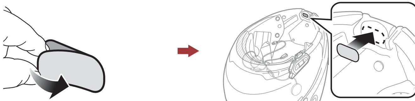
2. Coloque el micrófono con cable en la sujeción con cierre autoadherente de bucle para el micrófono con cable.
