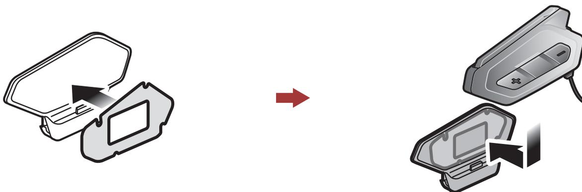
3. Introduzca la placa posterior de la unidad de sujeción entre el acolchado interno y la carcasa externa del lateral izquierdo del casco.
