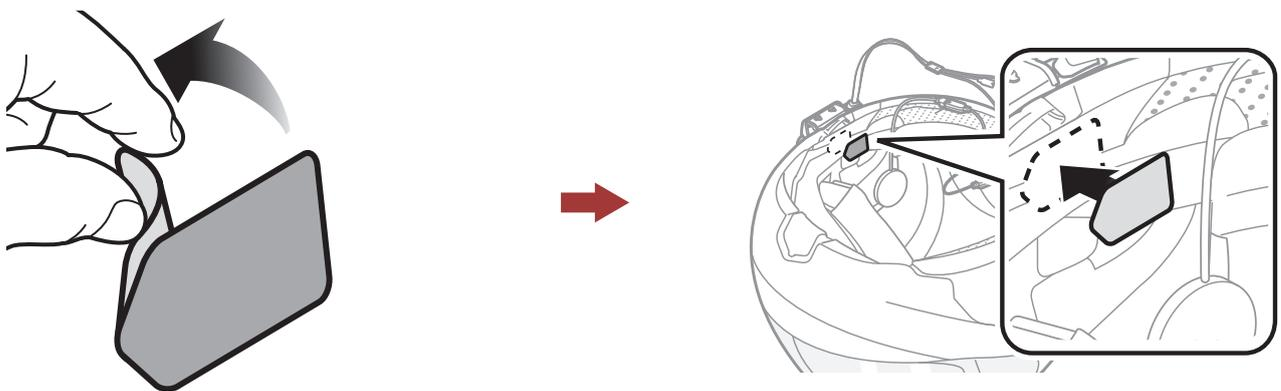
2. Coloque la placa de montaje del micrófono con brazo y cable en la sujeción con cierre autoadherente de bucle.
